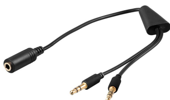
Conexión 3.5 mm 4 vías Hembra a PC
