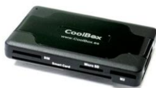
Lector de tarjetas y DNI Memorias: DNI SIM y SmartCard (DNle), MS2 micro y MicroSD sin adaptadores además de las habituales para SD/SDXC/ MMC
