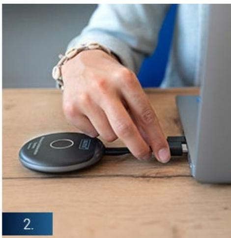
2. Conecte el transmisor con la conexión USB y HDMI de su PC. El transmisor y el receptor establecen automáticamente una conexión.
