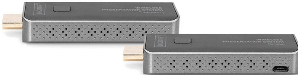
El kit Click & Present Mini transmite señales de vídeo y audio HDMI por vía inalámbrica a una distancia de hasta 50 m con visión libre. Conmute de forma rápida y sencilla con un botón al emisor deseado para reproducir sus contenidos
