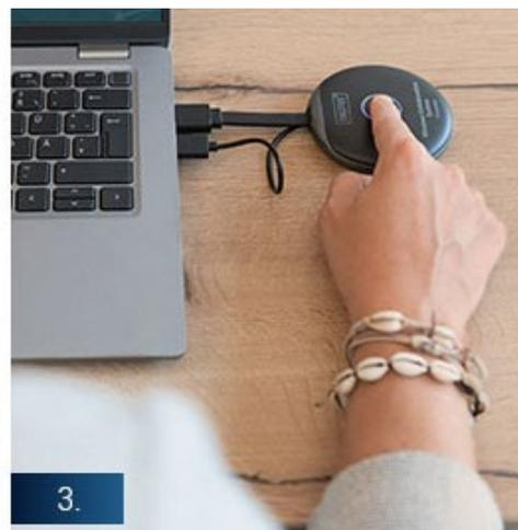
3. A continuación, pulse el botón de conexión en el transmisor para iniciar la transmisión de su contenido de pantalla.
