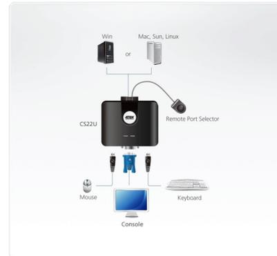
Switch KVM cableado de 2 puertas USB que permite seleccionar los PC conectados por selector de puertos. Ideal para aplicaciones que requieren alta calidad de video.
