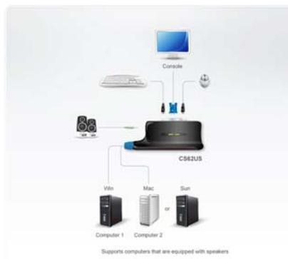
Conecte dos computadoras USB a una consola USB, para obtener un sistema informático USB, compatible con todas las plataformas operativas: PC y Mac. Sistema Video DynaSync
