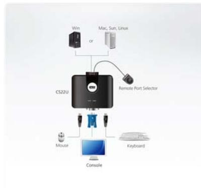
Switch KVM cableado de 2 puertas USB que permite seleccionar los PC conectados por selector de puertos. Ideal para aplicaciones que requieren alta calidad de video.
