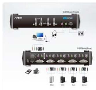
KVM que combina un conmutador de 4 puertos con un concentrador USB de 2 puertos hacia una pantalla DVI.
