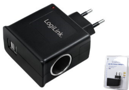
Convertidor 230 Vca a 12 Vcc. Toma encendedor Salida: 12 Vcc 1.000 Ma+2 USB 1.000MAH Entrada: 220 Vca
