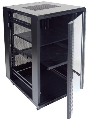
**Doble Puerta:** Existe la posibilidad de colocar una doble puerta en los armarios rack de gran tamaño, a partir de 800 mm. de anchura, que permite mantener cerrada una parte del armario mientras se trabaja en la otra.
